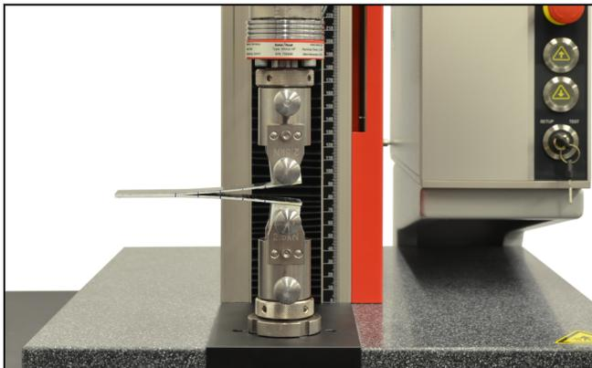
Vorrichtung zur  $G_{IC}$ -Prüfung an langfaserverstärkten Verbundwerkstoffen
