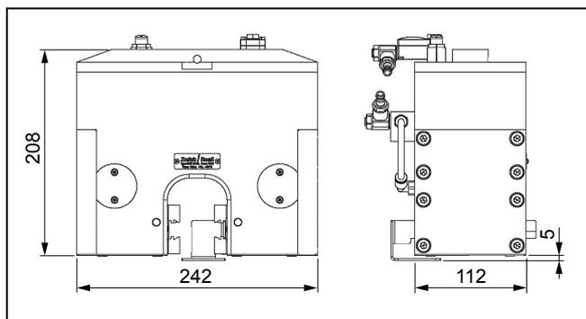
Pneumatik-Probenhalter Typ 8397,  $F_{max}$  10 kN, Übersicht
