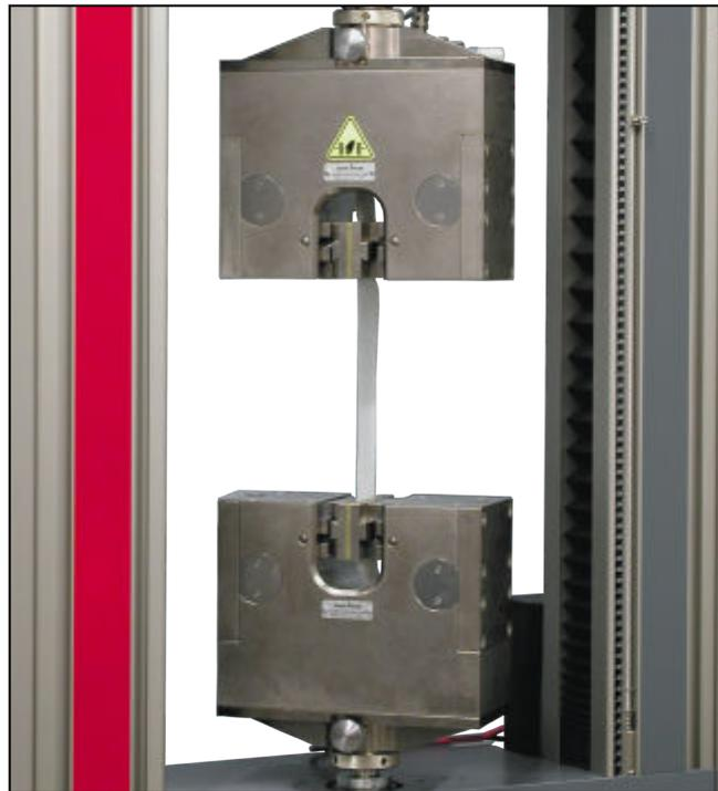
Pneumatik-Probenhalter Typ 8497,  $F_{max}$  20 kN
