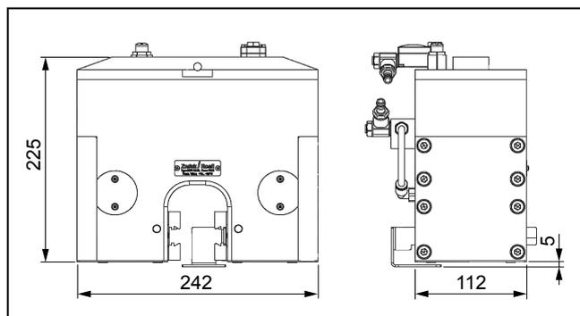
Pneumatik-Probenhalter Typ 8497,  $F_{max}$  20 kN, Übersicht
