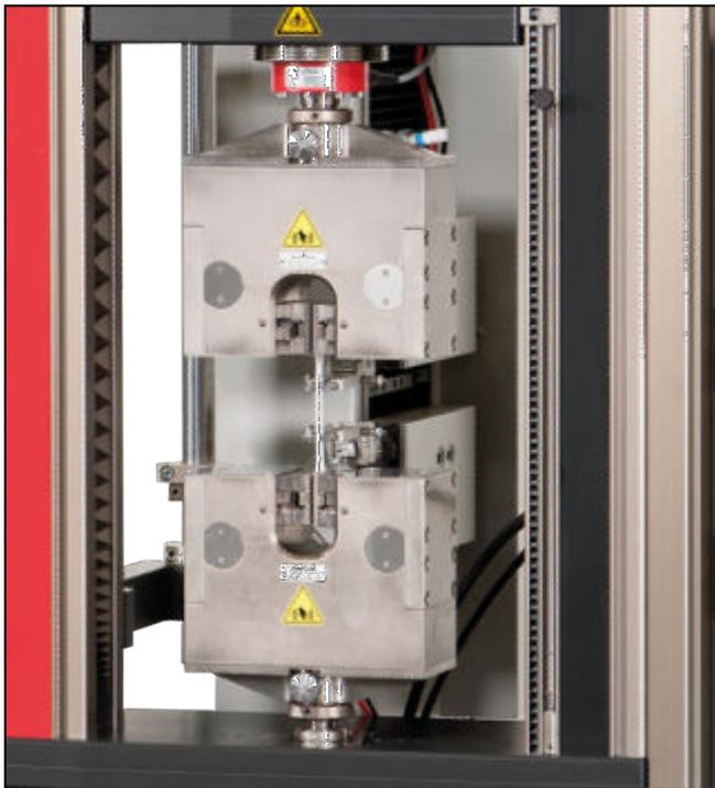
Pneumatik-Probenhalter Typ 8397,  $F_{max}$  10 kN
