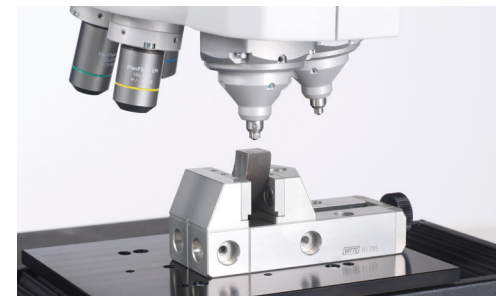
Vickers Härteprüfer: der Revolver passt sich unterschiedlichen Prüfmethode an
